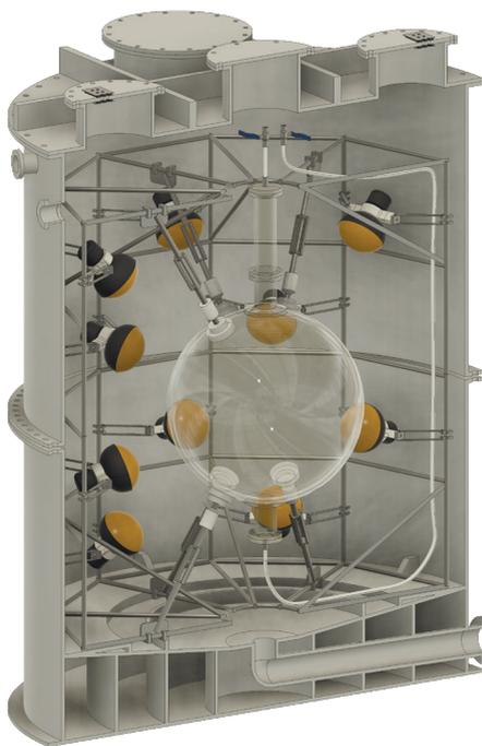
*Рис. 8.* Модель полутонного прототипа ББНТ
