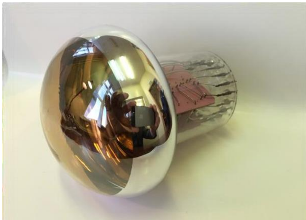
Рисунок 4.1. Фотография образца разработанного 3-х дюймового полусферического фотоумножителя производства ООО «МЭЛЗ ФЭУ».
