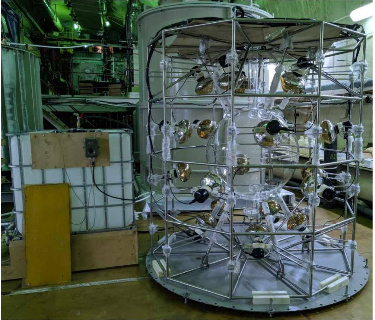
Рисунок 2.32. Фотография прототипа детектора: каркас с установленными в нем фотоумножителями, акриловая сфера, резервуар для воды (на заднем плане) и контейнер из полиэтилена высокой плотности, из которого сцинтиллятор вводится в сферу.
