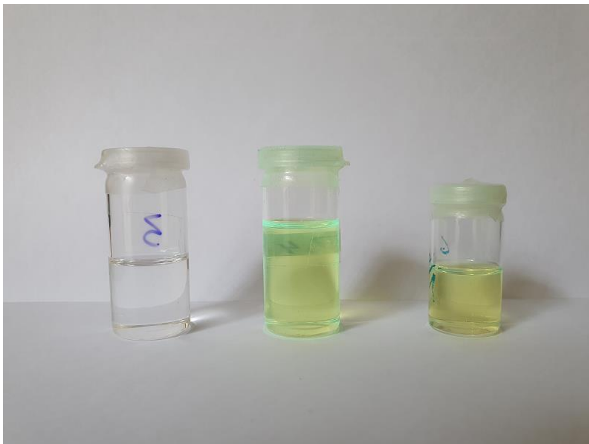
Рисунок 2.21. Фотография двух образцов жидких сцинтилляторов с новыми добавками Skm219 (справа и в центре) и стандартный сцинтиллятор с LAB+PPO (слева).
