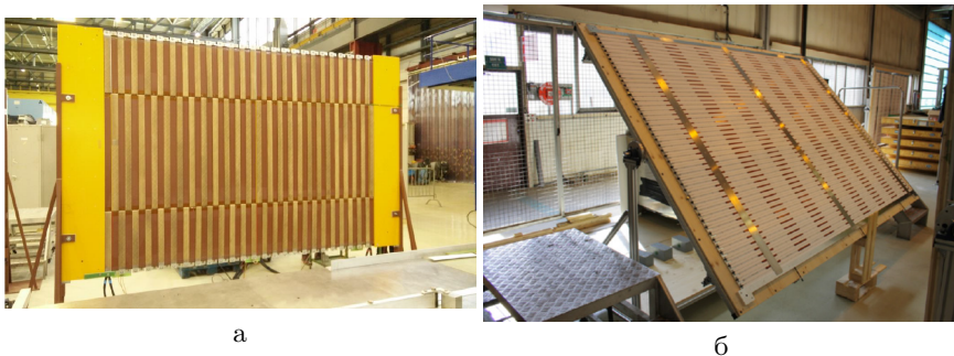
Рис. 2 — а — Фотография собранного магнитного модуля детектора Baby MIND. б — Фотография собранной половины сцинтилляционного модуля.
