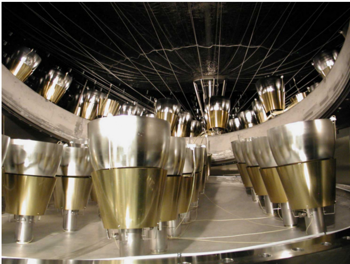
Рисунок 1.4 — Магнитный экран ФЭУ в детекторе Bogexino [32].
