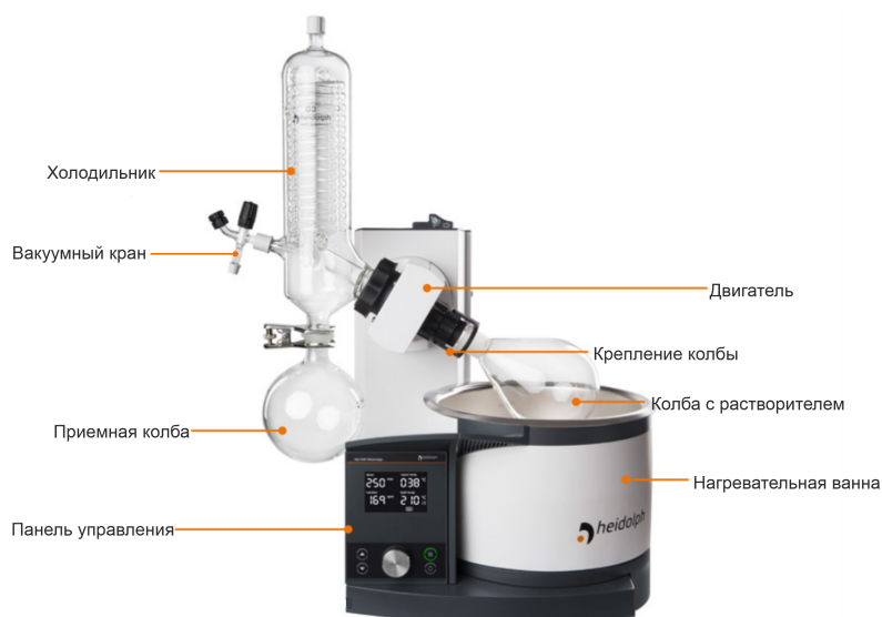
Рисунок 4.2 — Устройство роторного испарителя Heidolph.
