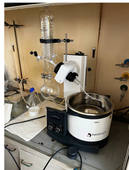
Рисунок 4.2 — Устройство роторного испарителя Heidolph.
