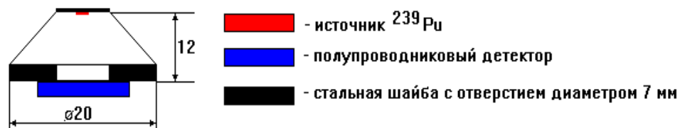
Схема датчика с \alpha источником и полупроводниковым детектором
