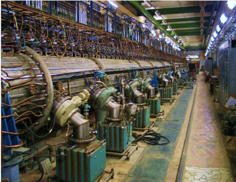
**5 резонаторов с трубками дрейфа**
