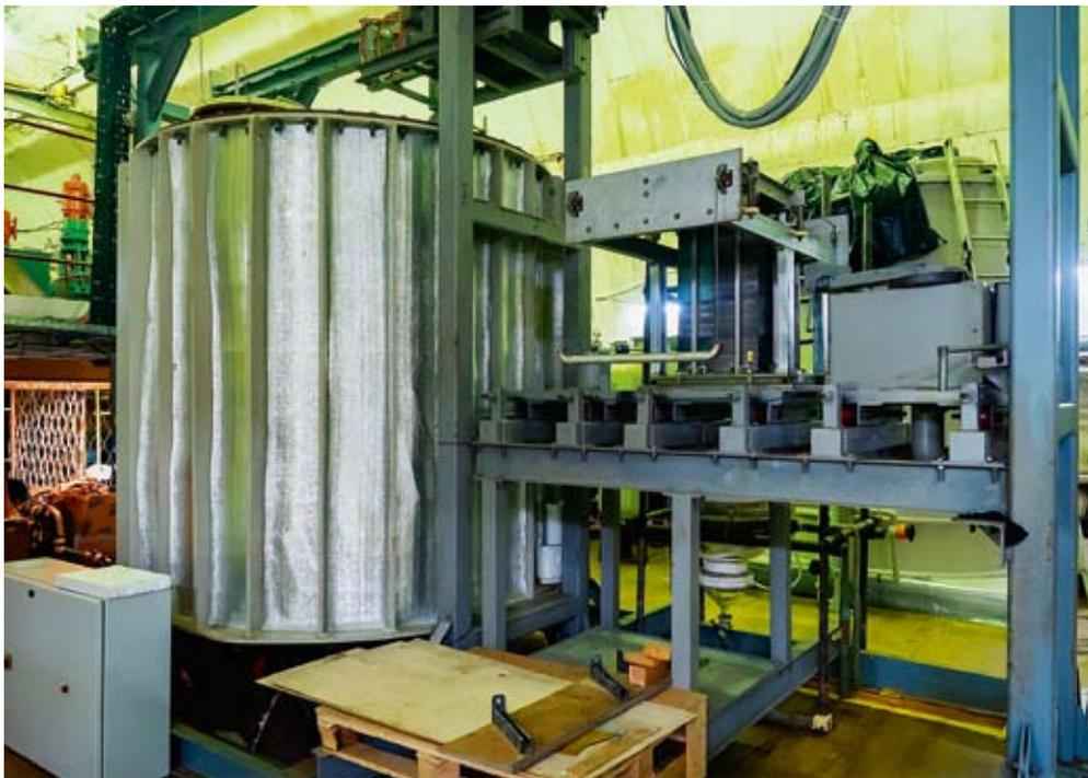
Установка эксперимента BEST. Слева — ёмкость для облучения галлия, в центре виден массогабаритный макет источника нейтрино на основе изотопа Cr-51 интенсивностью 3,4 МКи.
