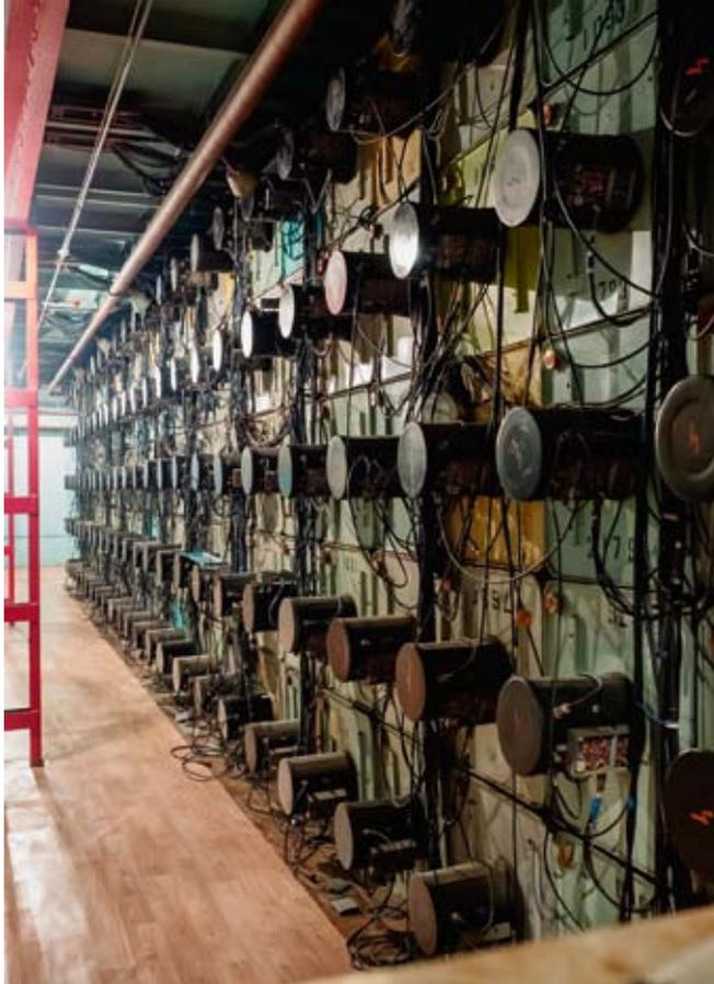
*Вертикальная плоскость Баксанского подземного сцинтилляционного телескопа (БПСТ).*
