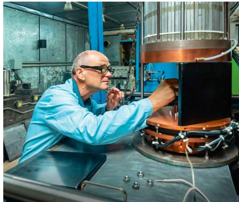
*А. А. Шихин работает со счётчиками системы регистрации ГГНТ, они — на фото справа, где сверху виден колодец в кристалле NaI(Tl) антисовпадетельной защиты. (На верхнем снимке счётчики загораживают крышка.)*
