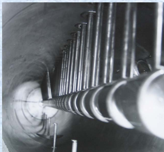
Внутри резонатора №1 после окончания радиотехнической настройки
