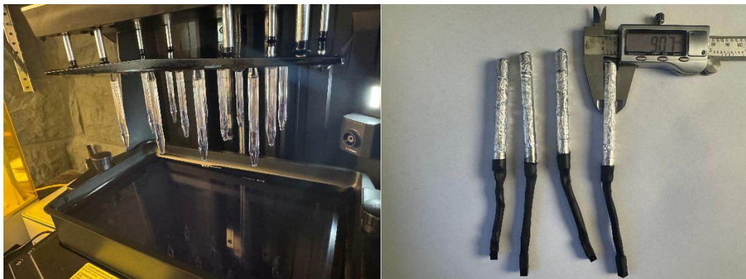
Рисунок 1.6 – Внешний вид световода и детектора, слева – заготовки сцинтиллятора, справа – собранный детектор нейтронов
