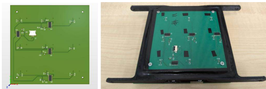
Рисунок 14 – Проект платы (слева), слой прототипа нейтронного детектора с установленным светодиодным калибратором (справа)
