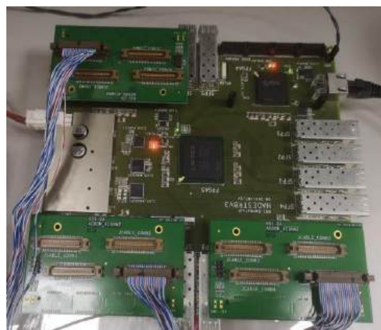
Рисунок 42 – Электроника считывания в двух вариантах исполнения для подключений к различным детекторам (слева), и модуль оцифровки (справа) на 128 каналов с разрешением 10 пс на отсчет
