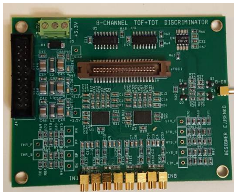
Рисунок 41 – Многофункциональная электроника считывания для времяпролетных камер RPC и электромагнитного калориметра ECal с дополнительными функциями и возможностями для изучения параметров TOT метода с различными камерами
