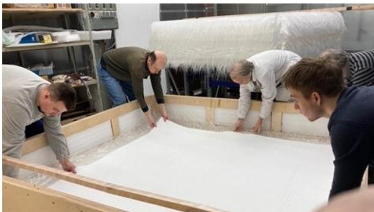
Рисунок 27 – Упаковка слоев с кубиками SFGD в транспортировочный ящик для отправки из ИЯИ РАН в J-PARC
