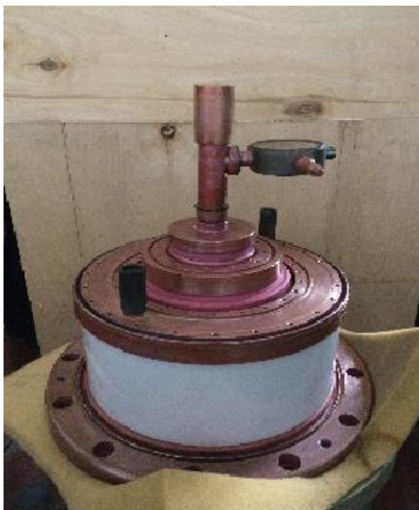
Рисунок 3 – Генераторная лампа ГИ-71А с вакионом в катоде
