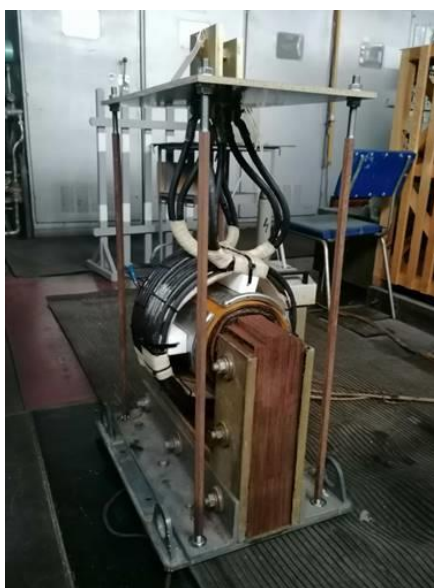
Рисунок 8 – Фотография нового разработанного и изготовленного накального трансформатора
