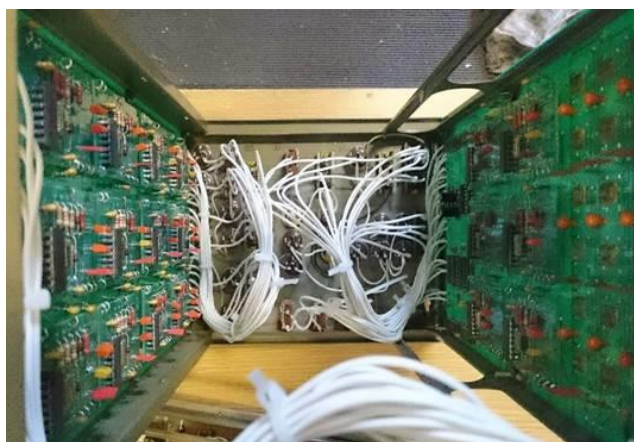
Рисунок 14 – Внешний и внутренний вид блоков размножения сигналов
