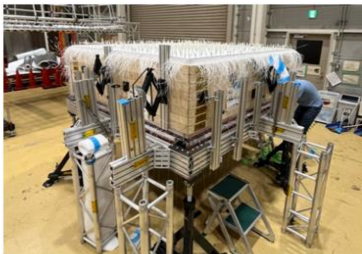
Рисунок 2 – собранные вместе на лесках слои детектора 3D SuperFGD в JPARC, Япония, перед установкой во внешний бокс
