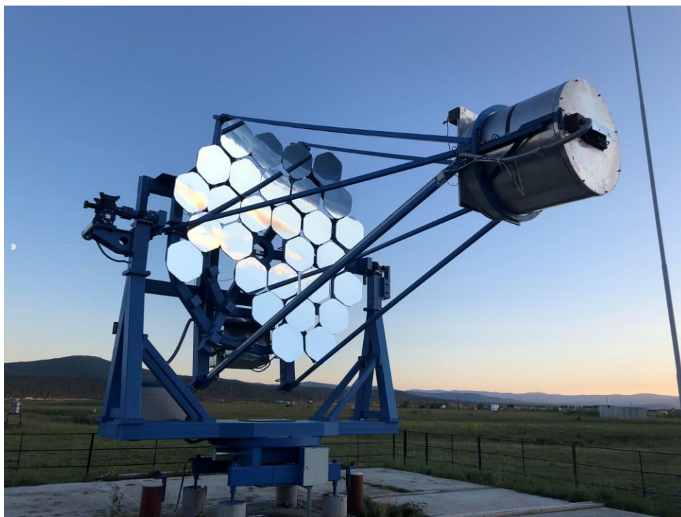
Рисунок 14.1 - Третий телескоп TAIGA-IACT в эксперименте TAIGA
