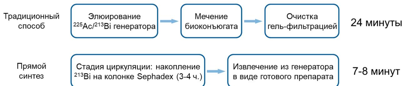
Рисунок 1.9 – Сравнение длительности получения  $^{213}\text{Bi}$ -радиоиммуноконъюгата по традиционному способу и прямым синтезом в циркулирующем  $^{225}\text{Ac}/^{213}\text{Bi}$  генераторе
