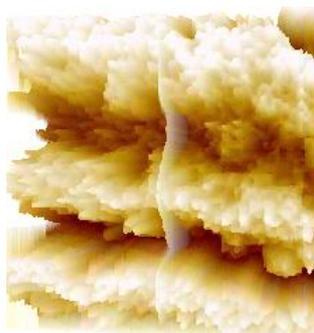
Рисунок 8.2 – Структура магнитных вихрей, обнаруженная с помощью магнитного силового микроскопа в локальной области  $1 \times 1 \text{ мкм}^2$  нанографитовой пленки при комнатной температуре
