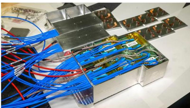
Рисунок 3 – Одна половина подсистемы FT0-A в процессе сборки
