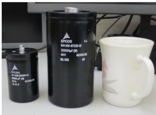
Рисунок 25 – Дополнительные фильтрующие конденсаторы блоков питания
