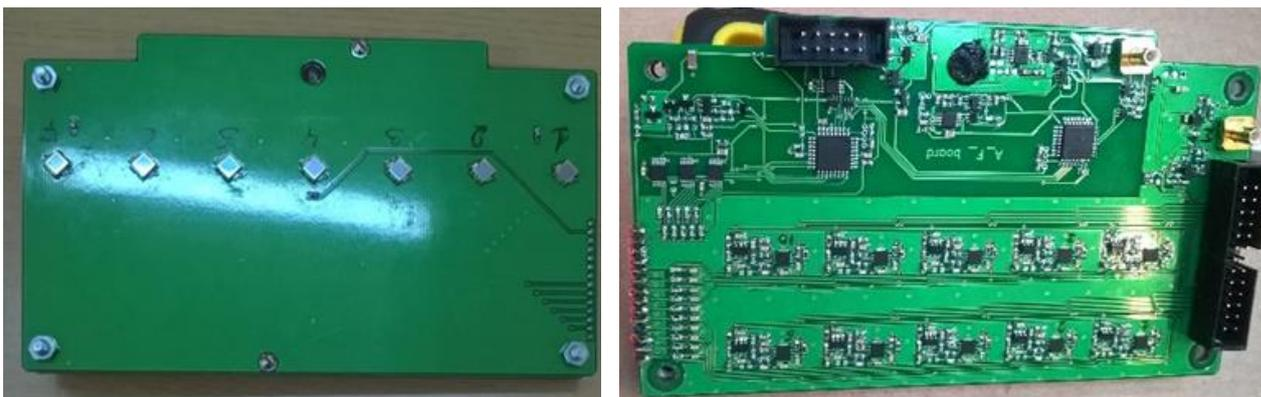
Рисунок 124 – Слева — плата с фотодиодами, справа – плата с аналоговой электроникой для считывания сигналов с фотодиодов
