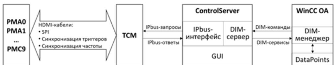
Рисунок 44 – Схема взаимодействия DCS с FEE через ControlServer
