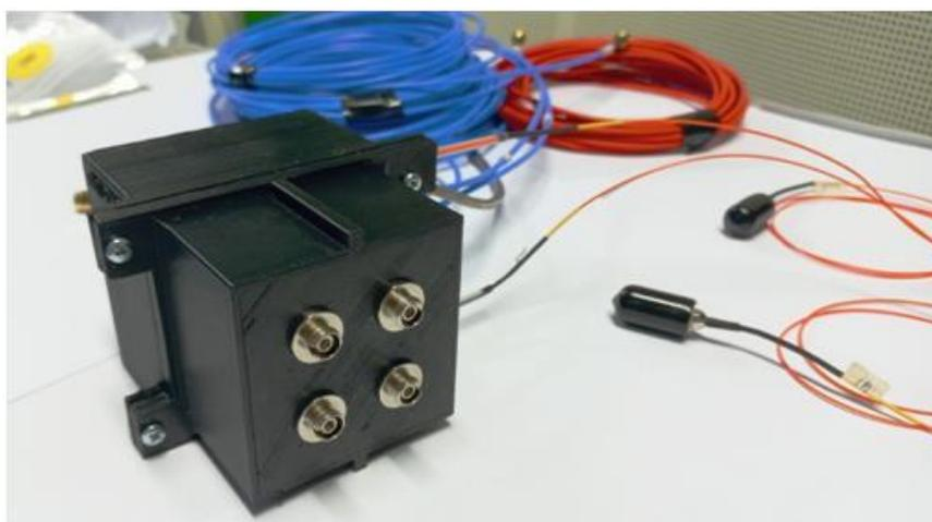
Рисунок 17 – Фотография референсного МКП-ФЭУ со стороны входных портов для мониторинга интенсивности «возвратного» света
