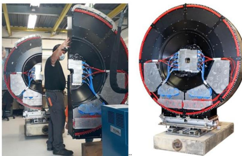
Рисунок 7 – Внешний вид подсистем FT0-A и FV0, оснащённых системой кабельных креплений, в процессе их интеграции друг с другом (слева) и после интеграции (справа)
