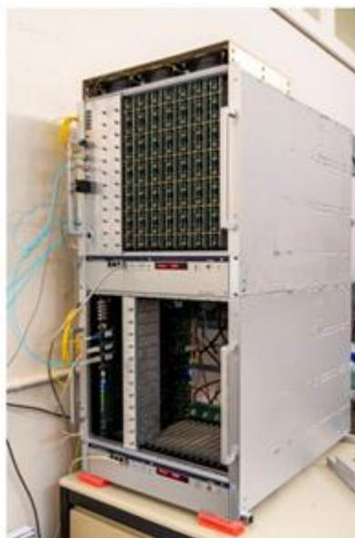
Рисунок 21 – Тестовый стенд для электроники детектора FIT
