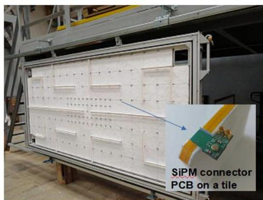
Рисунок 133 – Сборка нового сцинтиляционного годоскопа фрагментов в институте ИЯИ РАН (г. Троицк) (слева). Вид детектора с установленными сцинтиляционными пластинами (справа). На врезке справа представлен вид крепления платы с фотоумножителем к оптическому выводу пластины
