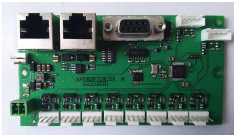
Рисунок 28 – Плата контроля вентиляционной панели FCB
