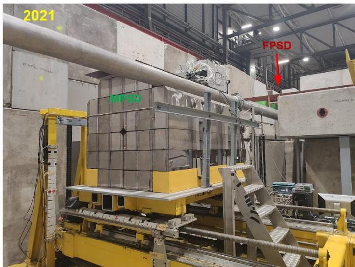
Рисунок 79 – Фото системы калориметров (MPSD и FPSD) на пучке ускорителя SPS на эксперименте NA61/SHINE в 2021 г. Калориметр FPSD закрыт бетонными блоками радиационной защиты
