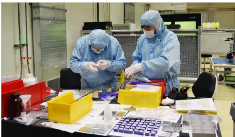
Рисунок 2 – Подготовка компонентов детектора FIT для сборки в чистой комнате DSF в ЦЕРН
