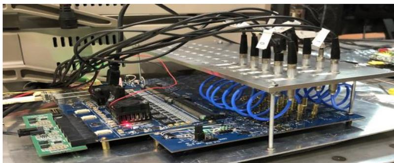
Рисунок 109 – Фотография платы ECAL@ADC64 в сборе с интерфейсным блоком
