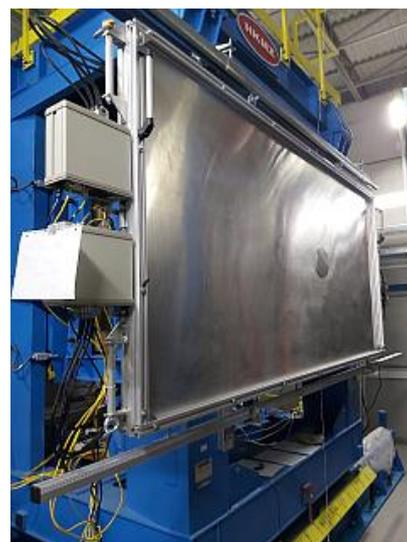
Рисунок 134 – Вид модуля с источником питания кремниевых фотоумножителей, цепей усилителей и считывающей электроники АЦП ADC64s2. Изготовлено в “HVSys” (ОИЯИ, Дубна) (слева). Вид на детектор, установленный на раме калориметра FHCAL с блоками электроники (справа)
