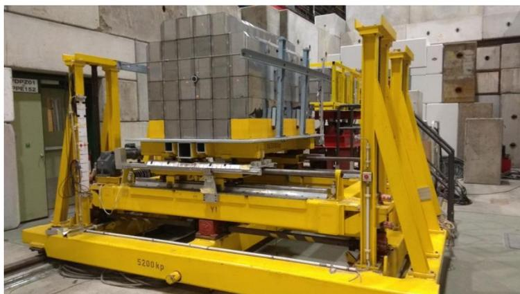
Рисунок 78 – На переднем плане показано фото модернизированного калориметра установки NA61/SHINE с отверстием в центре калориметра для прохождения пучковых ионов свинца. На заднем плане виден дополнительный калориметр, собранный из девяти модулей (без пучкового отверстия)
