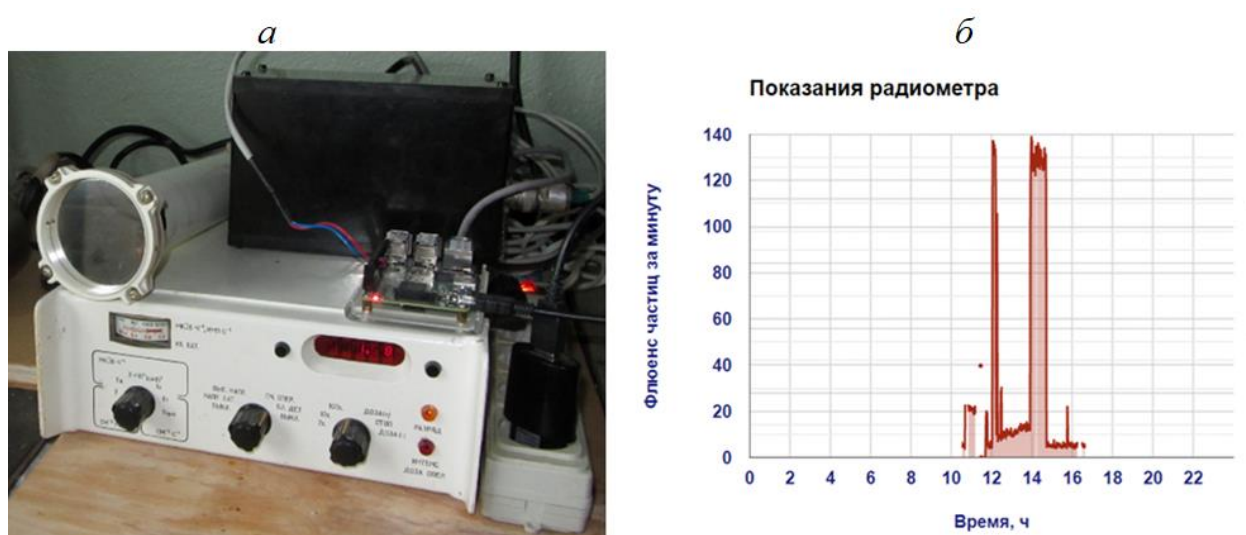
Рисунок 62 – а: радиометр МКС-01Р с бета детектором и модулем управления Raspberry Pi; б: диаграмма потока бета частиц, измеренного с помощью радиометра МКС-01Р.
