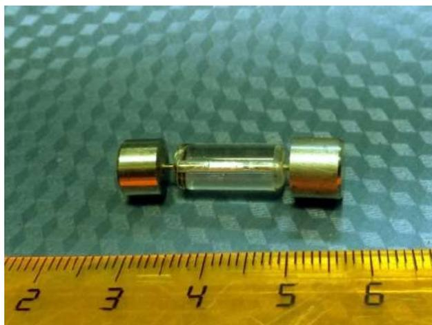
Рисунок 51 - Пресс-форма с матрицей из толстостенного стеклянного капилляра
