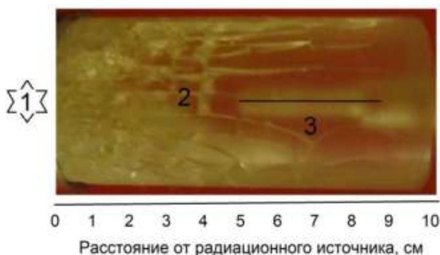
Рисунок 57 - Повреждение акрилового материала при радиационном облучении; 1 – радиационный источник; 2 – образец из оргстекла с полостью; 3 – металлические частицы внутри образца.
