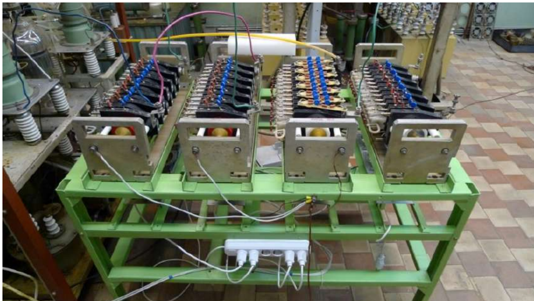
Рис. 3. Тиристорные ключи модулятора генератора высоковольтных импульсов инжектора протонов.
