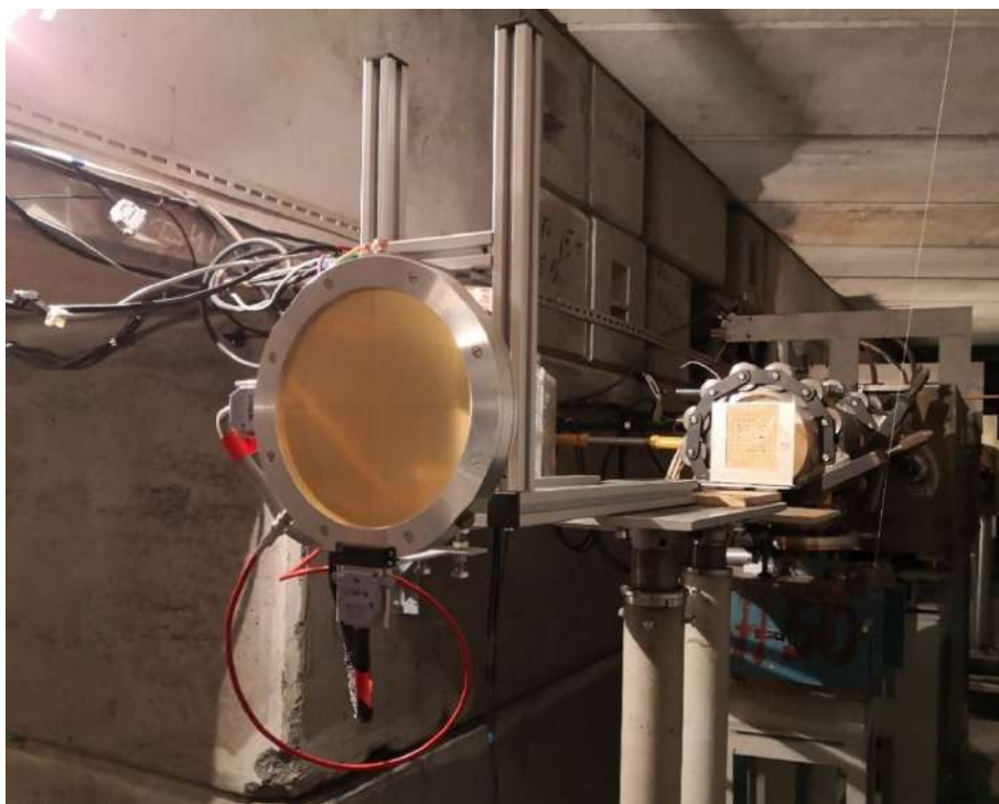
Рис. 5. Мультианодный газовый счётчик и люминофор на входе в комплекс протонной терапии.
