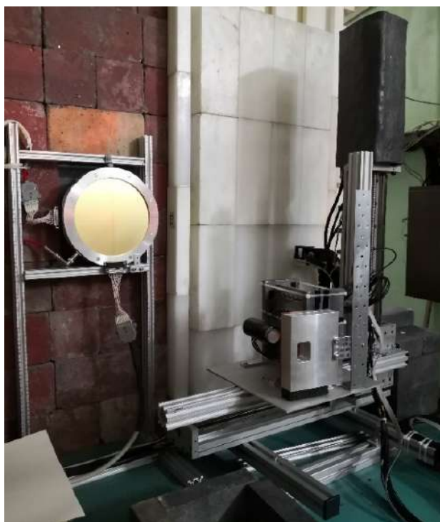
Рис. 2. Испытания спектрометра космических лучей МФТИ – ИКИ РАН на экспериментальном стенде.
