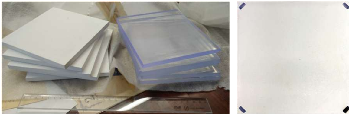
Рисунок 28 – Сцинтилляционные пластины из полистирола для прототипа мюонного детектора SHiP (~20 см x ~20 см x ~1 см), предложенные сотрудниками ИЯИ РАН и изготовленные методом экструзии на производстве ООО УНИПЛАСТ, г. Владимир. Слева: пластины с отражателем, полученным методом травления; в центре: пластины без отражателя; справа: пластина с 4 канавками для фотосенсоров
