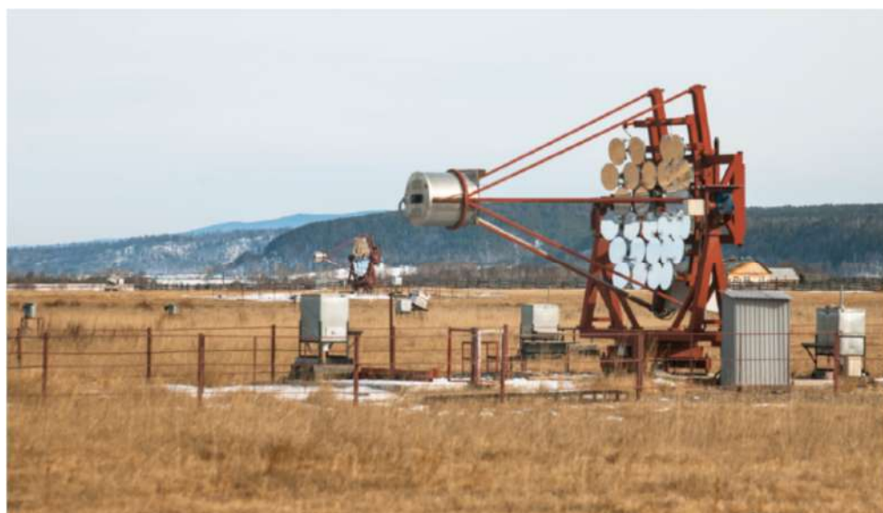
Рис. 30. Два действующих узкоугольных атмосферных черенковских телескопа TAIGA-IACT в составе экспериментального комплекса TAIGA.
