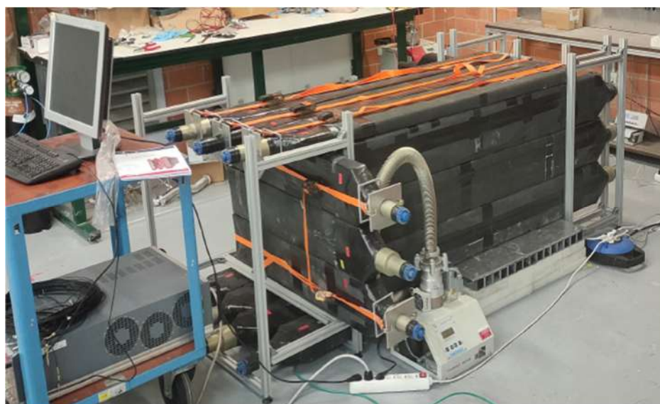
Рисунок 7 – Детекторная установка IAXO-DO с мюонным вето
