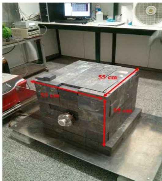
Рисунок 4 – Детекторная система IAXO-D0 в пассивной свинцовой защите
