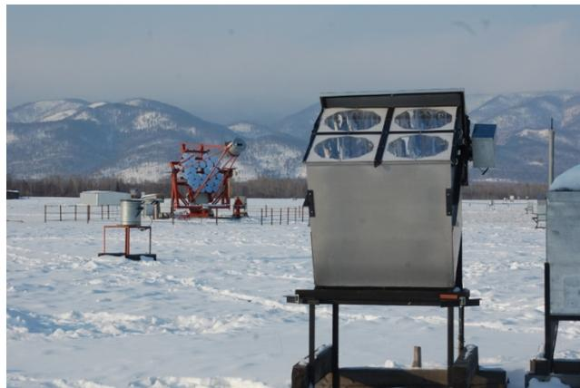
Рис. 32. Один из черенковских атмосферных телескопов изображения TAIGA-IACT (слева) и одна из оптических станций черенковской широкоугольной установки TAIGA-HiSCORE (справа).
