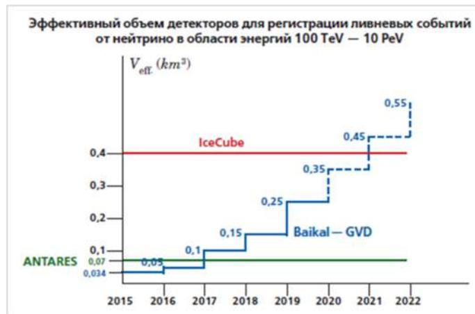
Рис. 1. Рост эффективного объема телескопа Baikal-GVD в результате установки новых кластеров
