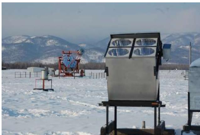
Рис. 8.4.2. Один из черенковских атмосферных телескопов изображения TAIGA-IACT (слева) и одна из оптических станций черенковской широкоугольной установки TAIGA-HiSCORE (справа).
