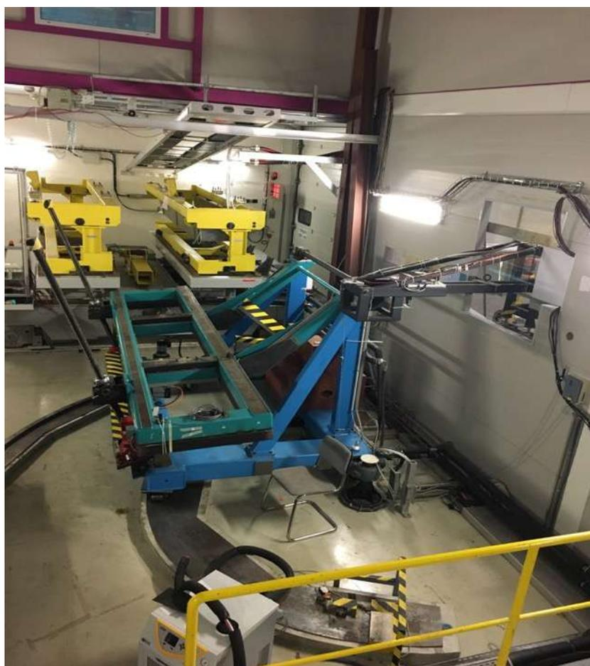
Рисунок 4.3.1. Подвижная платформа для размещения модуля электромагнитного калориметра.
