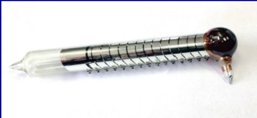
1 st photoelectron multiplier “Трубка Кубецкого” – “Kubetsky’s tube”
