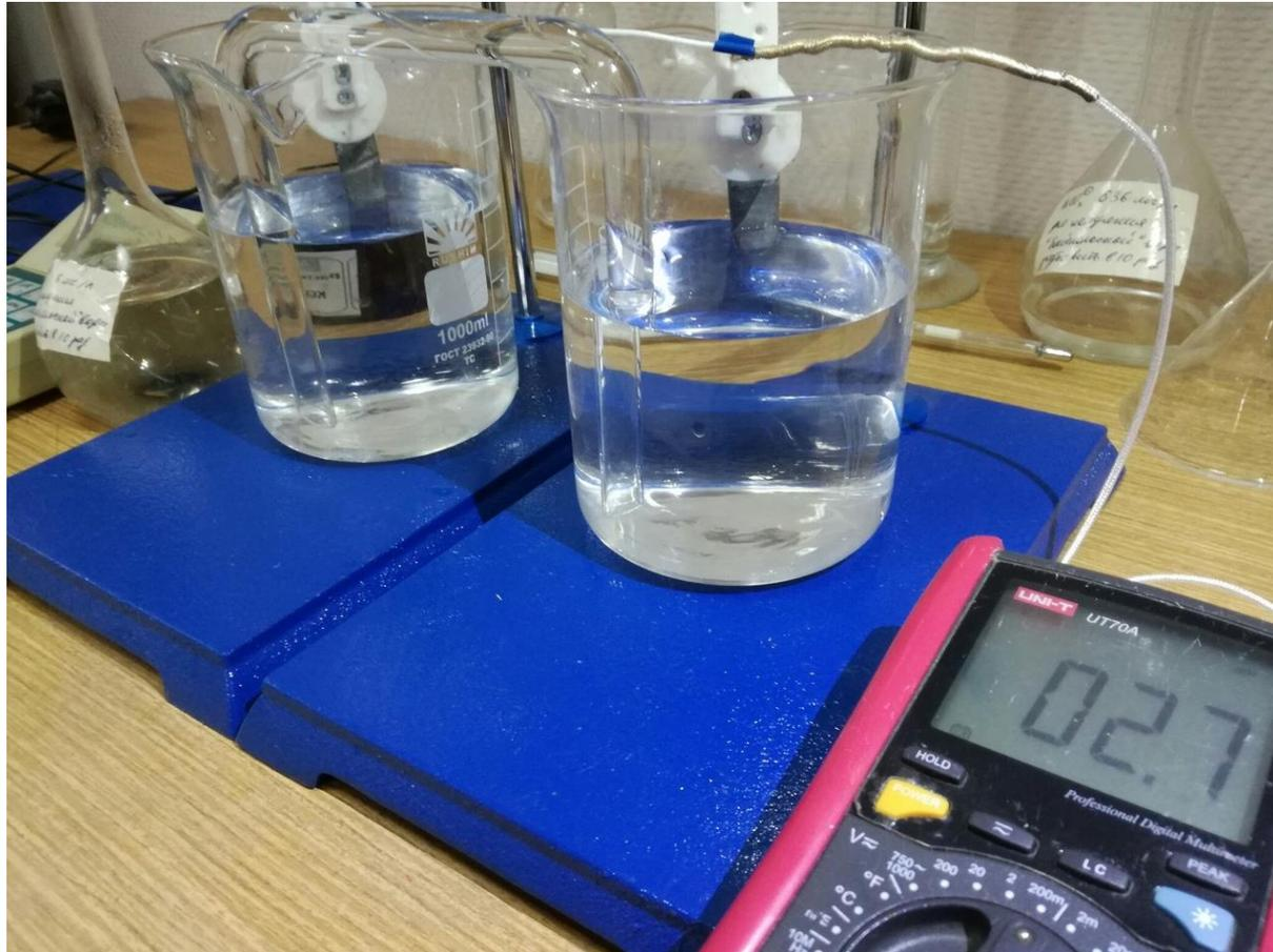
Электродвижущая сила  $\mathcal{E}$  концентрационного гальванического элемента с карбонатно-свинцовыми электродами второго рода равна разности электродных потенциалов, которые вычисляются по уравнению Нернста:
