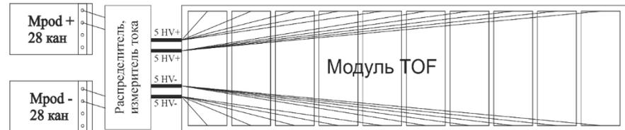
Схема распределения высокого напряжения в TOF МРД
