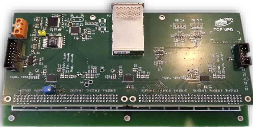
24-канальный усилитель-дискриминатор PA24N2V4L на базе чипа NINO с выходным разъемом MOLEX CXP
