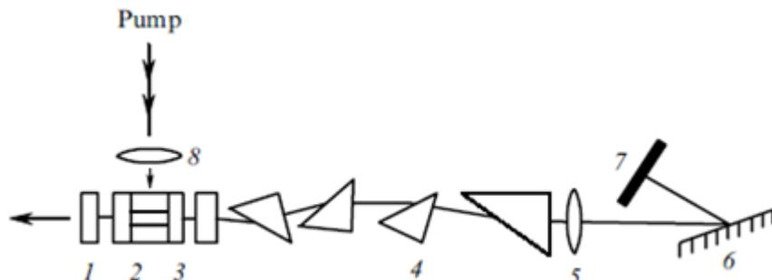
**Схема многомодового генератора не красителях:** (1) выходное зеркало; (2) кювета с красителем; (3) поляризатор
