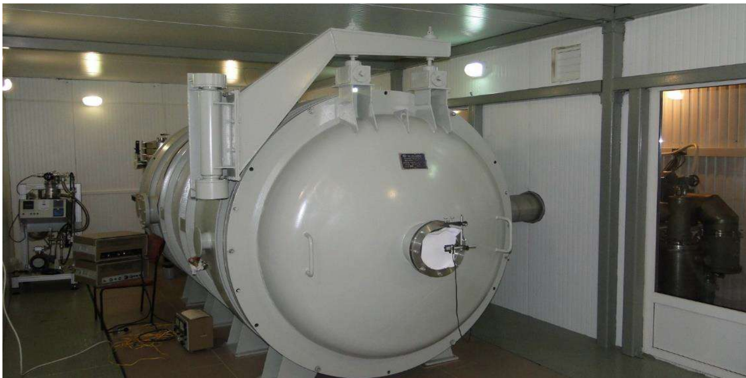
Рис 7 Вид загруженной внешней камеры оптоакустического детектора ОГАН в подземной лаборатории ПК-14 на антисейсмическом фундаменте за защитной панелью (справа).
