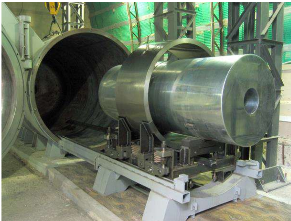
Рис 6 Вид конструкции детектора ОГРiН на испытательном стенде с кольцом опорной подвески и сейсмо фильтрами
