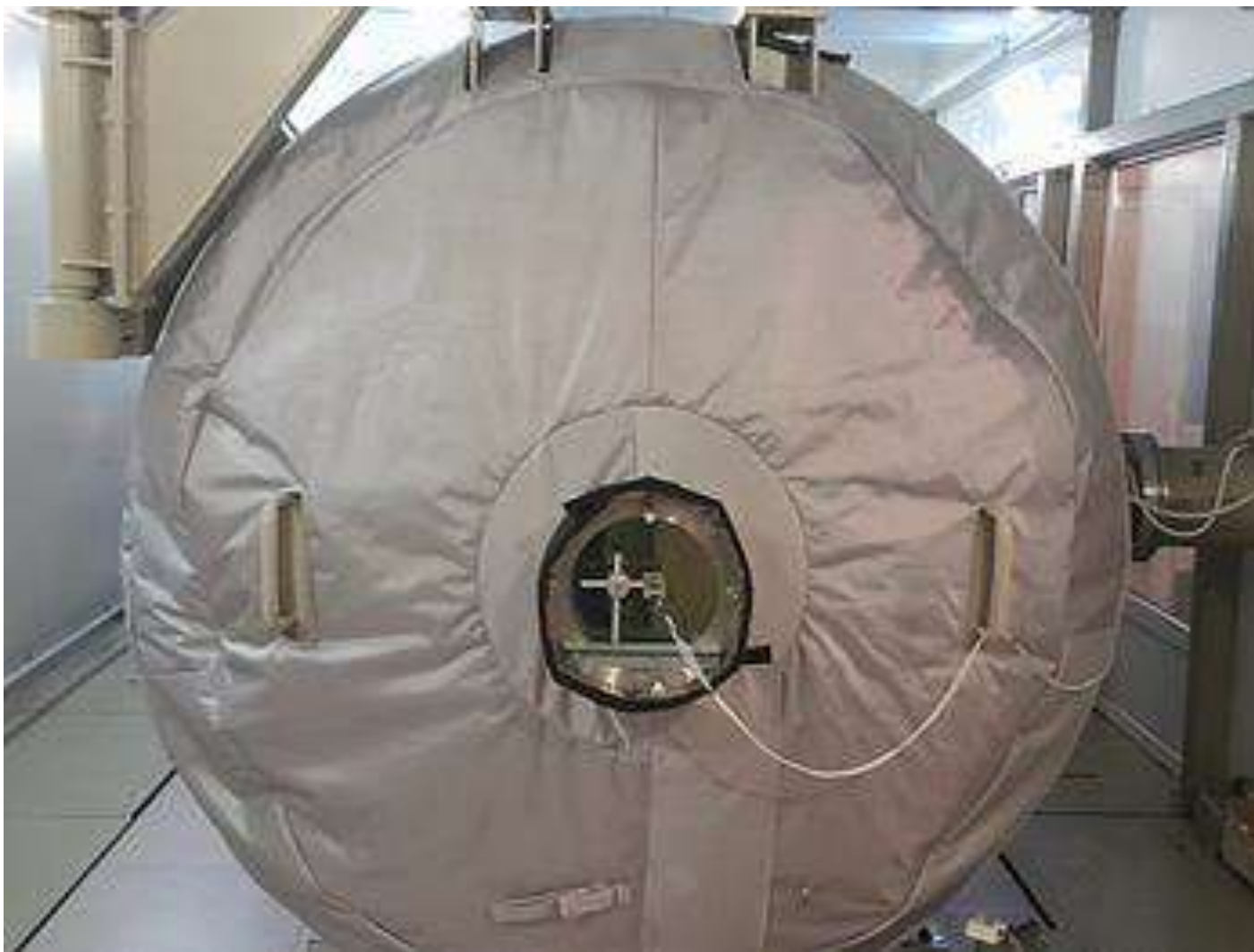
Рис 9 Камера ОГРАН (вид с торца) в чехле активного термостата поддерживающего температуру камеры с точностью 0.01 К
