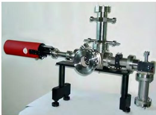
▲ Рис.17. Внешний вид прибора для измерения формы сгустков ускоряемых частиц
