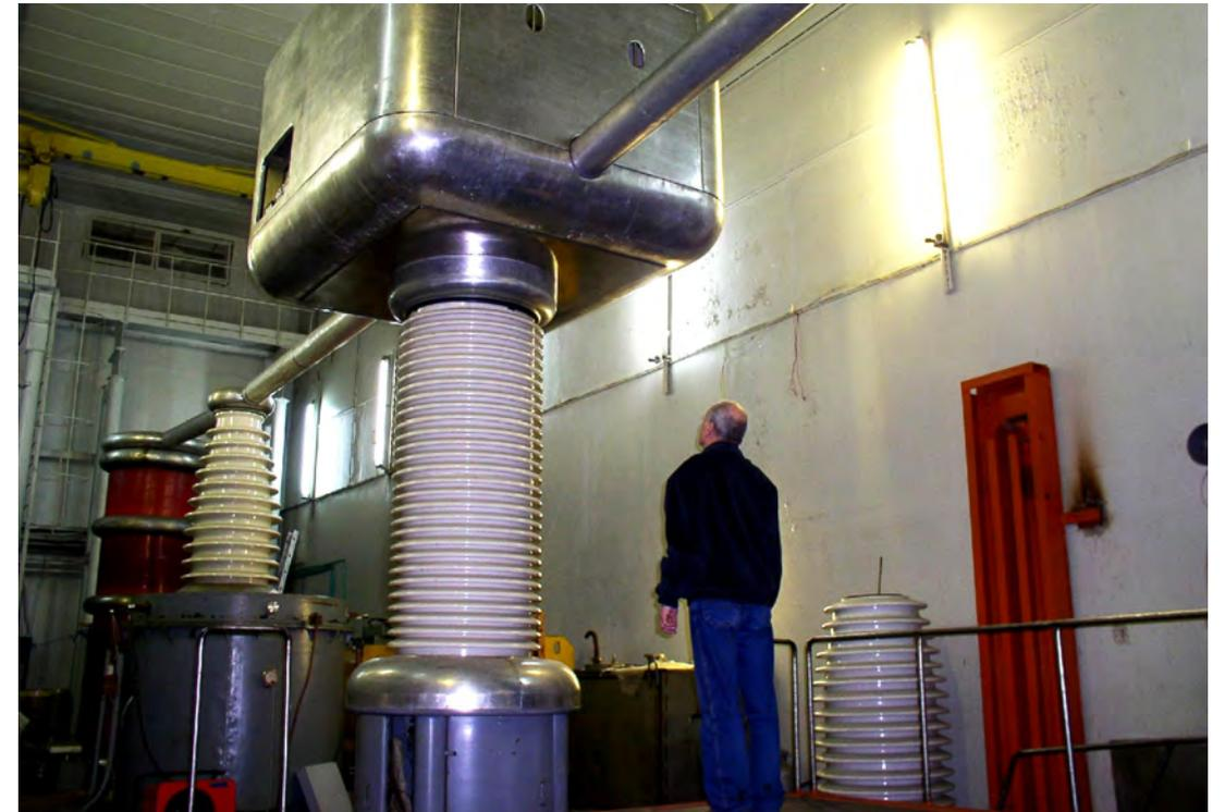
▲ Рис.3. Инжектор протонов линейного ускорителя
