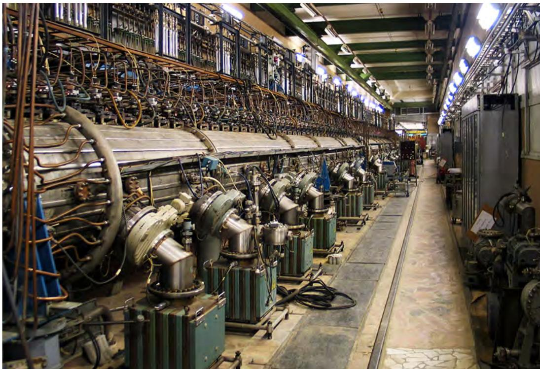
▲ Рис.5. Ускоряющие резонаторы с трубками дрейфа начальной части (100 МэВ)
