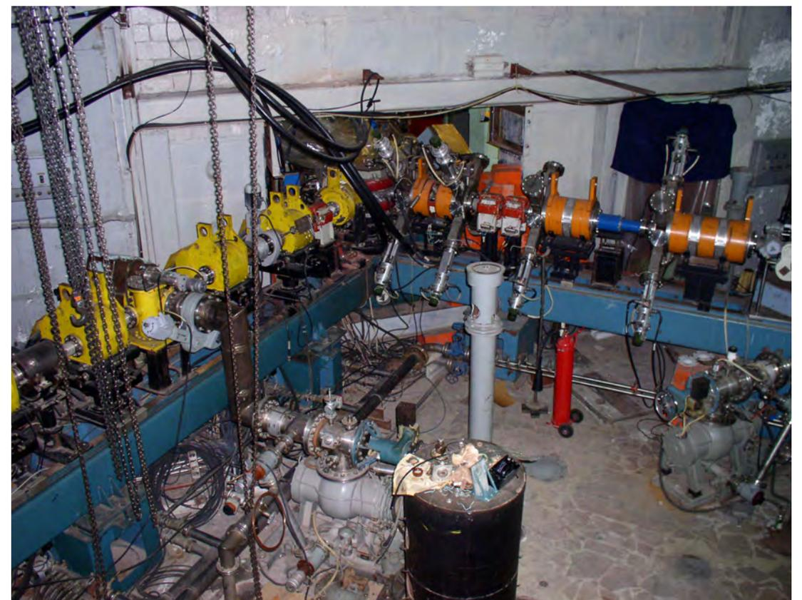
▲ Рис.4. Инжекционные тракты протонов (слева) и ионов H- (справа)
