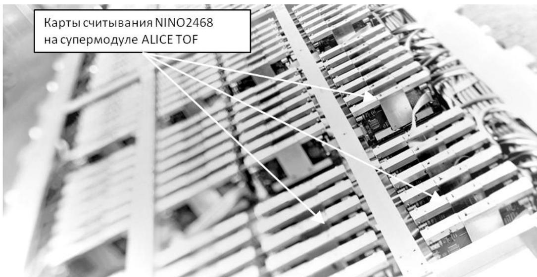
Рисунок 41. Супермодуль TOF времяпролетной системы эксперимента ALICE с установленными 24-канальными картами накамерной считывающей электроники NINO2468.
