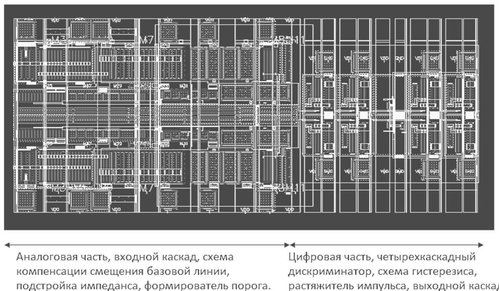
Рисунок 49. NINO-чип первой версии (показана топология одного канала) разработан в ЦЕРН (Швейцария), производство Клермон-Ферран (Франция) процесс IBM C-MOS 0,25  $\mu\text{m}$ , размер 2 x 4 мм, 76 выводов.
