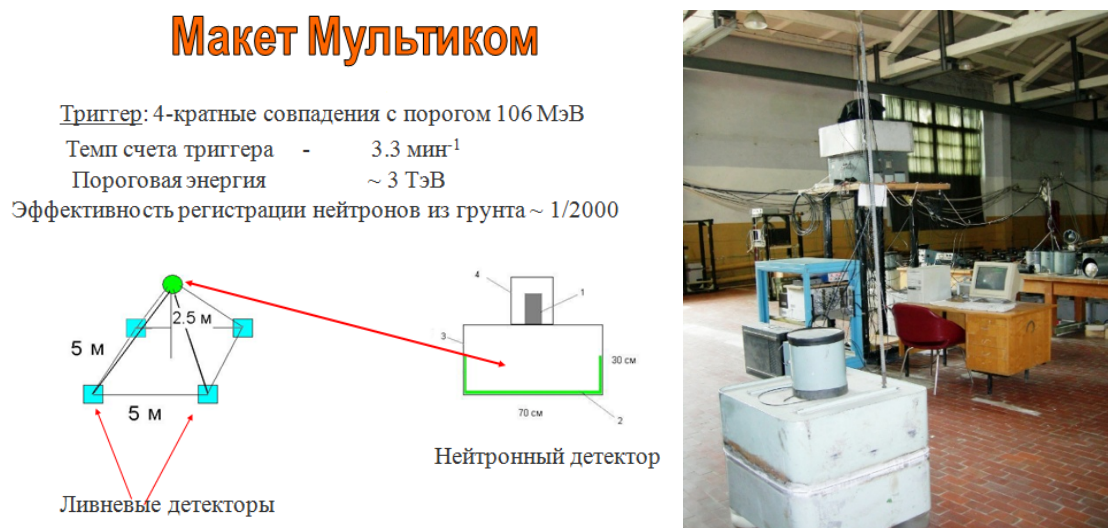
Рис. 6. Установка «Мультик», Баксанская нейтринная обсерватория ИЯИ РАН.
