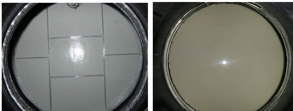
Рис. 8. Слева: сцинтиллятор ZnS(Ag)+{}^6LiF на дне детектора ( D=70 см). Справа: сцинтиллятор ZnS(Ag)+B_2O_3 на дне детектора ( D=70 см).
