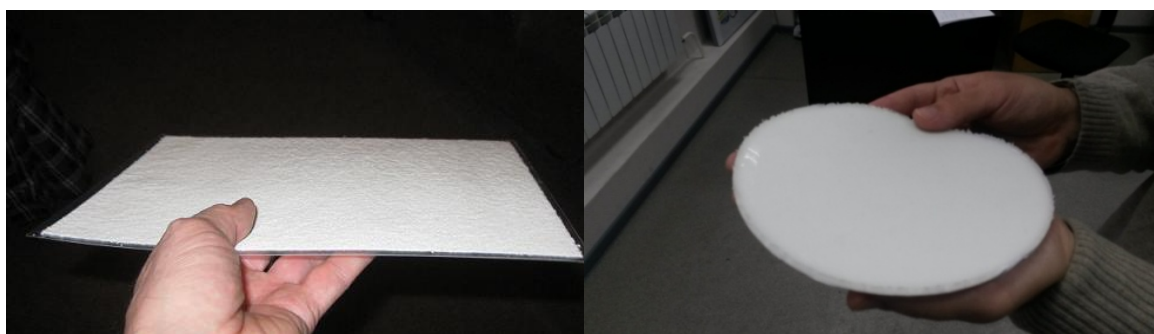
Рис. 7. Слева: образец сцинтиллятора ZnS(Ag)+{}^6LiF , порошок средней толщиной 30 \text{ мг/см}^2 заламинирован на белой бумаге. Данный сцинтиллятор был использован в установках МУЛЬТИКОМ, PRISMA-32, PRISMA-YBJ. Справа: образец сцинтиллятора ZnS(Ag)+B_2O_3 , толщиной 50 \text{ мг/см}^2 залит на белой бумаге в жидкую резину. Данный сцинтиллятор использован в установке URAN.
