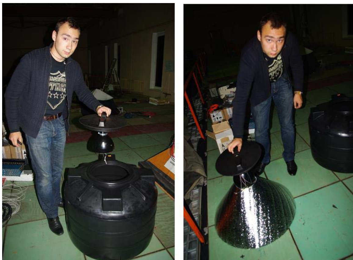
Рис. 10. Эн-детектор в разобранном виде. Фото сделано в экспериментальном комплексе НЕВОД в ходе сборки установки PRISMA-32 (2011 г.).
