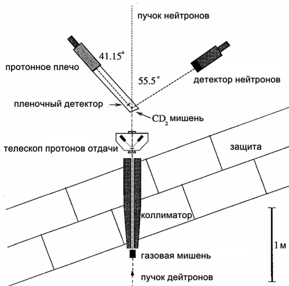
Рис. 6.3. Экспериментальная установка BONN [104] для определения  $nn$  и  $np$  длин рассеяния в реакции  $nd$ -развала. Пояснения к геометрии и элементам установки в тексте.
