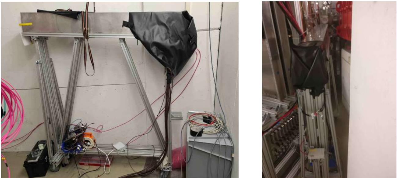
Рис. 11 — Фотография модуля mPSD на установке mCBM в «положении обслуживания» (слева) и направленным на мишень в «пучковом положении» (справа).
