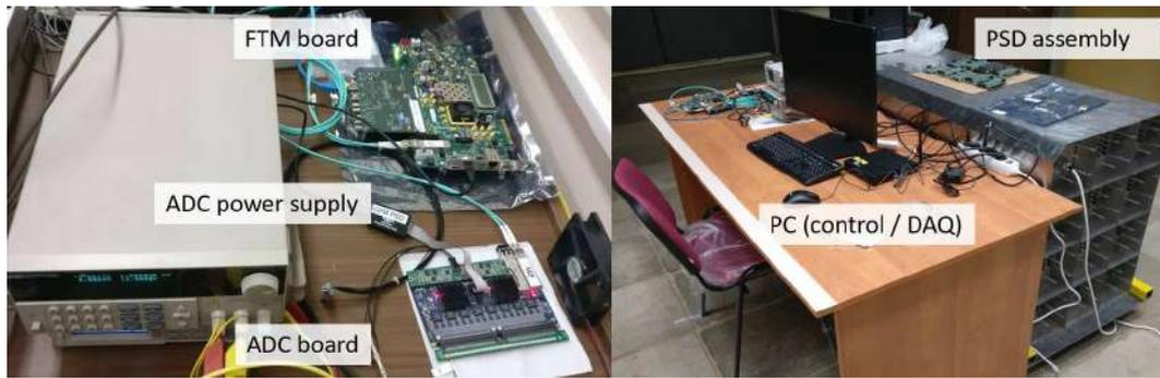
Рис. 10 — Испытательный стенд для разработки системы сбора данных калориметра PSD. Слева: плата ADC подключенная к плате «FTM board»; справа: фотография стенда по сбору данных с модулей калориметра PSD.
