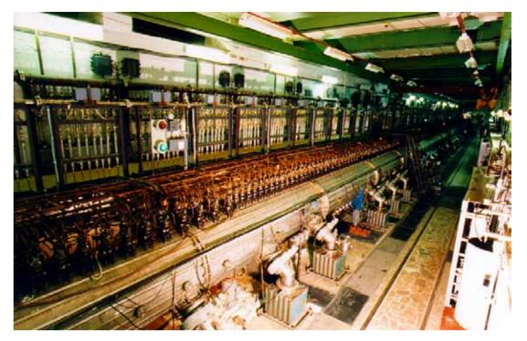
Рис. 5. Начальная часть ускорителя ионов водорода, обеспечивающего работу нейтронного комплекса
