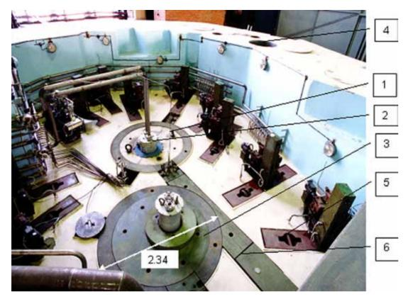
Рис.11. Фотография центральной верхней части комплекса источников нейтронов: 1 — бокс импульсного источника нейтронов, 2 — верхняя часть мишенного модуля, 3 — второй бокс, 4 — вертикальные проходки для установки дополнительного экспериментального оборудования, 5 — нейтроноводы - 6 — стальная защита протонных пучков
