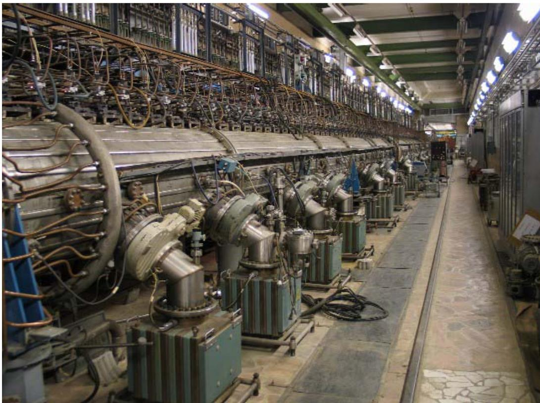
5 резонаторов с трубками дрейфа
