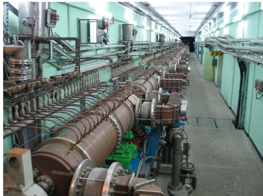
Ускоряющие резонаторы основной части ускорителя
