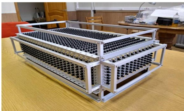
Рис.4. Прототип 3D сегментированного сцинтилляционного детектора.
