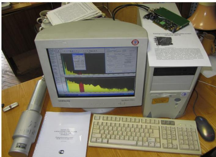
Рисунок 67 – Спектрометрического комплекса СКС-07П-Г41 для измерения радиационно-защитных свойств материалов.
