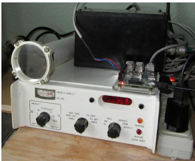
Рисунок 68 – Радиометрический узел испытательного стенда на основе радиометра МКС-01Р, детектора бета излучения и микрокомпьютера Raspberry Pi.
