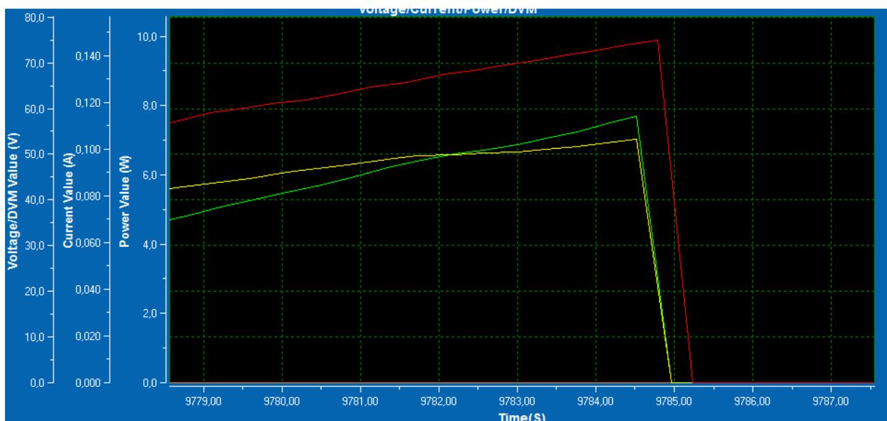
Рисунок. 71. Процесс переключения в нанографитовых пленках. Красным показано изменение напряжения, зеленым – мощности, желтым – изменение тока.
