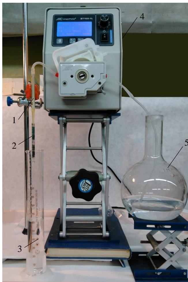
**Рисунок 46.** Схема прототипа  $^{225}\text{Ac}/^{213}\text{Bi}$  генератора с двумя сорбентами Т-5(100) и Т-35. 1 – колонка с сорбентом Т-5(100), содержащим  $^{225}\text{Ac}$ ; 2 – две колонки с сорбентом Т-35; 3 – элюат; 4 – перистальтический насос; 5 – раствор  $\text{NH}_4\text{Cl}$  (элюент).
