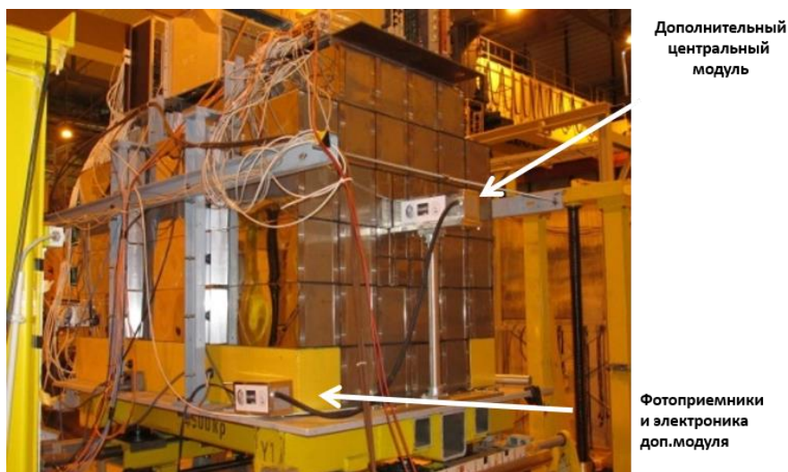
Рис. 25. Внешний вид переднего адронного калориметра установки NA61, используемого в экспериментах 2018г.
