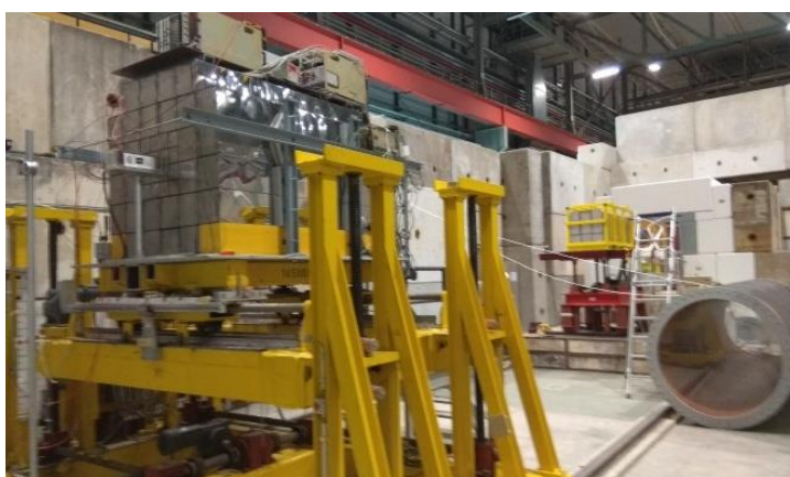
Рис. 28. Второй калориметр (F-PSD) (справа) на пучке NA61 ускорителя SPS. На переднем плане показан действующий калориметр.
