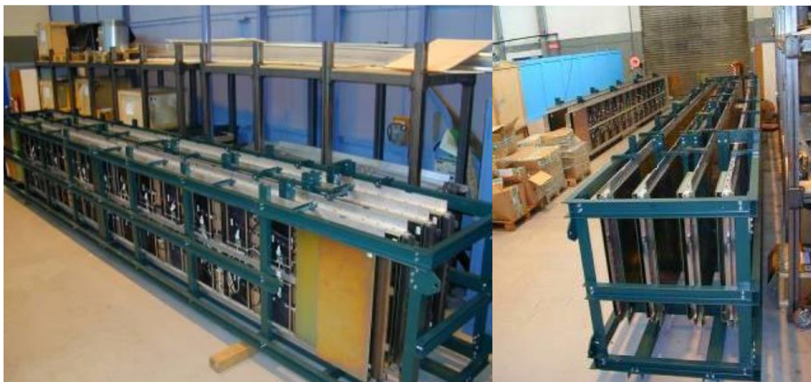
Рис. 43. Фотография корзины, изготовленной в ИЯИ для перевозки и хранения 4 супермодулей сцинтилляционно-падового и предливневого детектора и использованной для монтажа в 2008 г.
